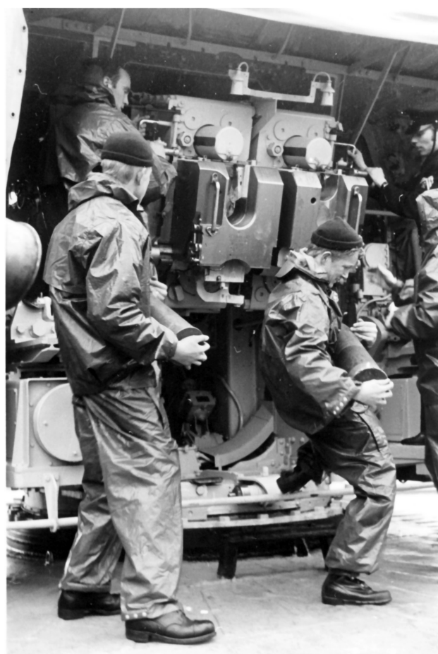
Her er kanonbesætningen godt i gang med betjening af pjecen. Det var tungt arbejde at være artillerist. Læg mærke til at besætningen er iklædt de nye "gummikampdragter". Læg også mærke til sergenten yderst til højre i billedet der optræder i jakkeuniform! Kanonen benyttede enhedsammunition, hvilket vil sige, at granat og ladning var een samlet enhed. (Marinens Biblioteks Arkiv)
